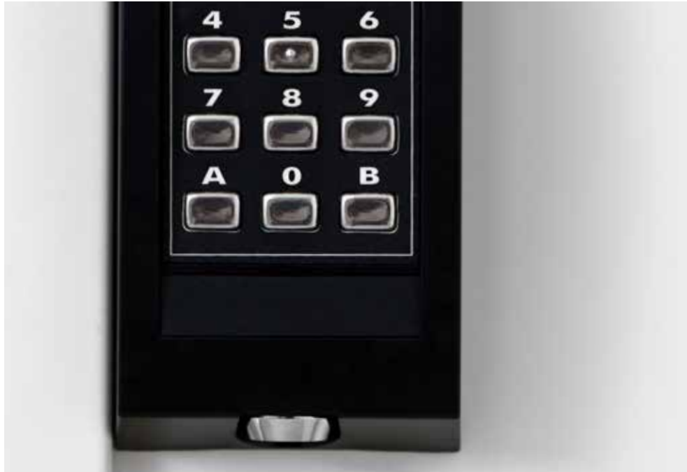
Bild 2. Inpassering med två-faktoridentifikation, tagg och sifferkod.
